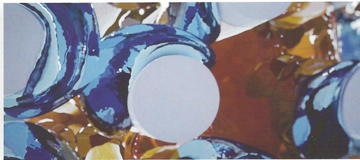
Az everStick üvegszálak rostok belülről. Különálló rostok, bis-GMA és PMMA a különleges IPN struktúra érdekében.
