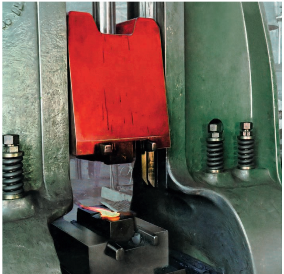
Tooth forceps hot forging process. Fase di stampaggio a caldo di una tenaglia per estrazioni.
